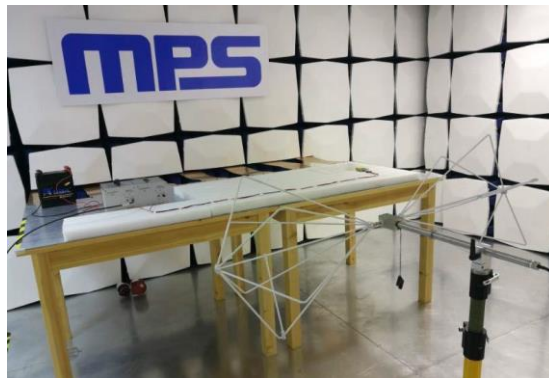
30MHz-200MHz Antenna: VHBB9124 (バイコニカルエレメント)
